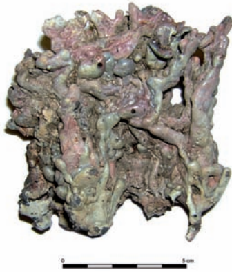
31. A. Goterones solidificados por enfriamiento al sumergirlas en líquido (BAS 2). B. Otro elemento del mismo proceso procedente del Depto. 249 (Casa 11) (BAS 3).
